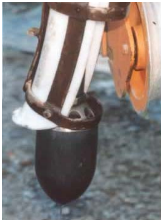
Abb. 2: Reinigungsdüse zur Hochdruckreinigung von Sickerwasserleitungen
