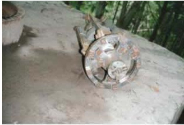
Abb. 3: Hochleistungsschlagbohrfräse zur Entfernung massiver Ablagerungen
