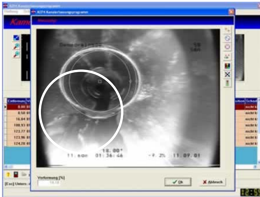
Abb. 7: Verformungsmessung im Kanaldatenerfassungsprogramm KEP 4.0
