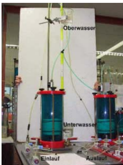
Bild 1: Versuchsanordnung zur Bestimmung der Durchlässigkeitsbeiwerte Sand/Bentonit-Mischung (Bild des IGBE der Uni Hannover)
