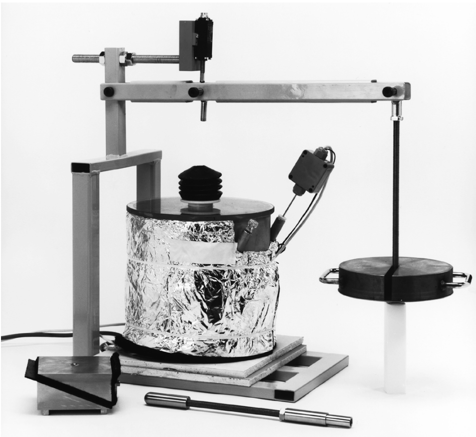
Bild 2: Probenhalter mit Kunststoffdichtungsbahn und Vliesstoff (links unten) und Gesamtansicht der Prüfeinrichtung.
