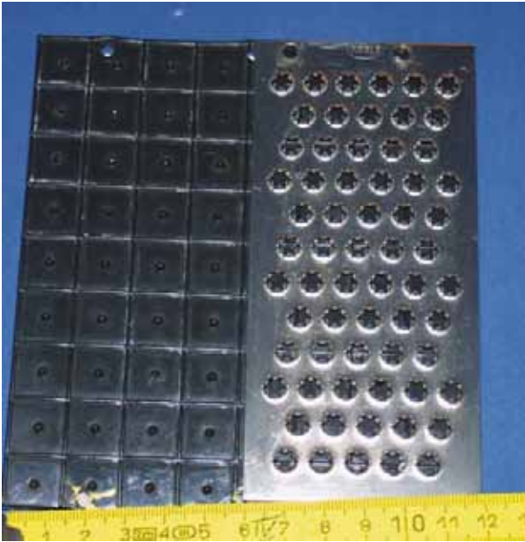
Bild 4: Strukturierte Kunststoffdichtungsbahn (KDB) und Reibblech, die auf den Keilen fest montiert werden und dann als Reibungspartner für eine vollflächiger Haftung der Keile auf der Ober- bzw. Unterseite der Bentonitmatten dienen.
