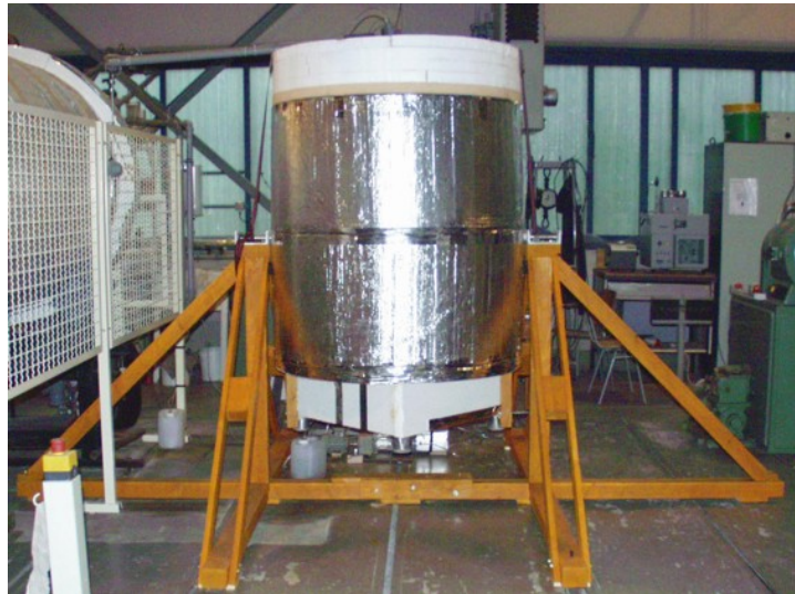
Abb. 6: 750 l -Schüttstichtreaktor im Betriebszustand
