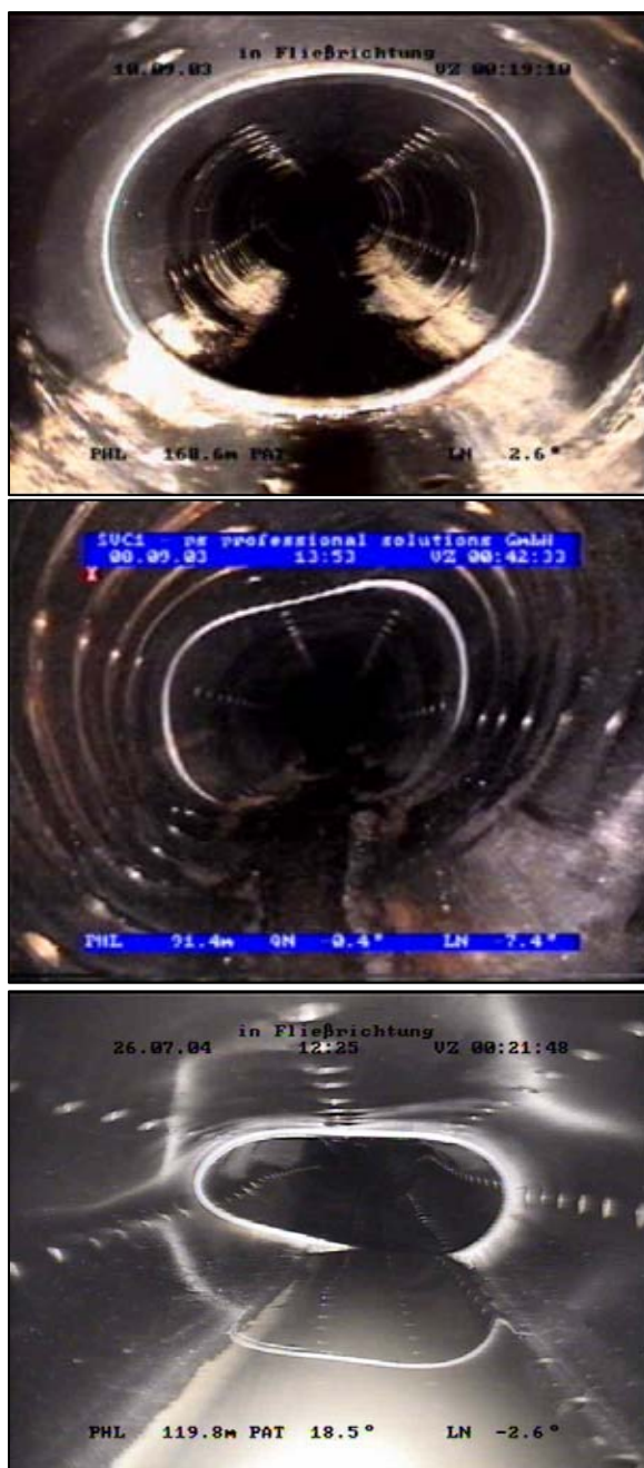
Bild 1 bis 3: Entwicklungsstadien bei der Verformung von PE-HD-Sickerrohren
