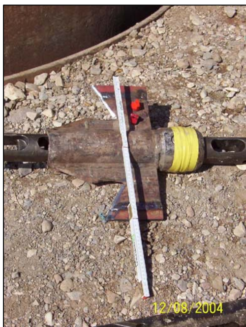
Bilder 12 und 13: Schneidkopf und Baugrube für die Durchführung des PE-HD-Berstverfahrens
