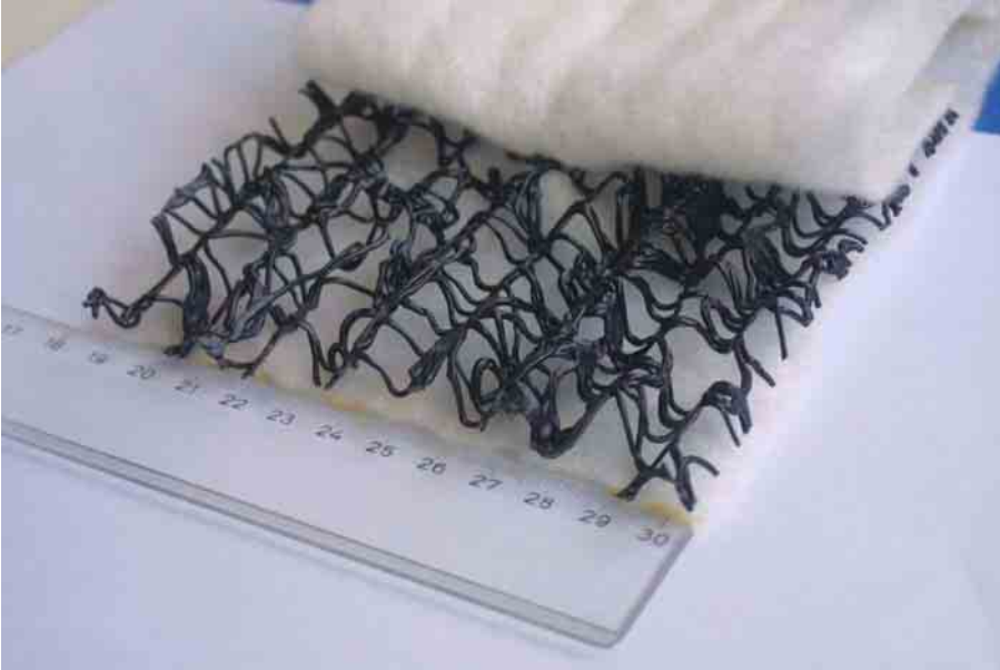
Abb. 2.1: Ausschnitt aus dem Kunststoff-Dränelement Secudrän® R201Z WD601Z R201Z.
