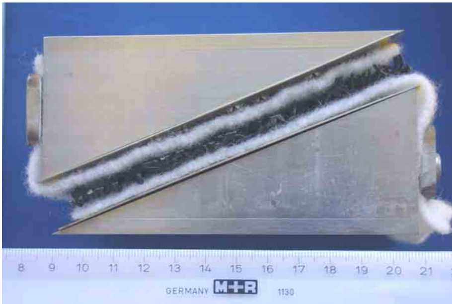
Abb. 9.6: Probehälter mit eingebautem Kunststoff-Dränelement Secudrän® R201 WD601 R201.
